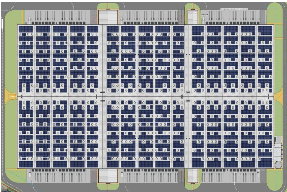
Plan d'implantation des panneaux photovoltaïques en toiture
